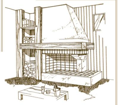
Ici, une cheminée rustique d'angle, ouverte à droite, composée d'un fover en carreaux réfractaires. Le jambage et le pilier soutiennent le fronton en briques réfractaires. Sur le côté, à l'angle de la cheminée, un colombage, aménagé en bûcher et en étagères, permet d'entreposer du bois, la poutre faisant partie intégrante du colombage. Une astuce déco qui permet de lier l'utile à l'agréable.
