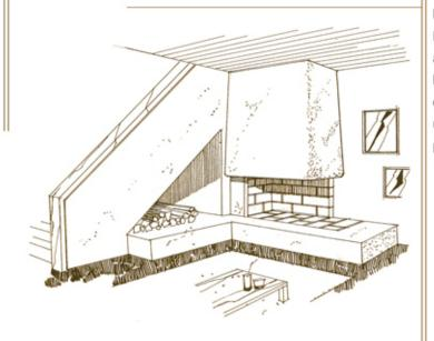
cheminée Une d'angle ouverte sur la droite, composée d'un foyer en briques réfractaires et d'une hotte légèrement en pente sans poutre. Le conduit de fumée se trouve dans l'angle de l'escalier et du murd'adossement.La soupente de l'escalier étant libre, on peut donc l'aménager en bûcher-réserve de bois.
