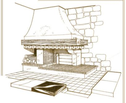
Cheminée rustique d'angle ouverture droite, composée d'un foyer en briques réfractaires. Un jambage et un pilier soutiennent le fronton et la poutre. La hotte rustique est légèrement galbée. Le bûcher est aménagé côté mur (gauche), séparé par un pilier en pierre, formant le côté de la cheminée. Le fronton et la poutre coiffent celui-ci en prolongement avec le foyer.
